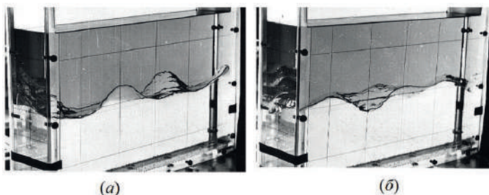
Рис. 2.63. Составные волны Фарадея (эксперимент): керосин - вода, \rho_1 = 0.79 \text{ г/см}^3 , \rho_2 = 1.00 \text{ г/см}^3 , h_{1,2} = 10 \text{ см} ; суперпозиция волновых мод (6,0) и (3,1) на частоте \Omega = 12.75 \text{ с}^{-1} : а, б – t=0 и T/2 .
