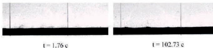
Рис. 2.70. Возмущение первоначально горизонтальной поверхности слоя осадков в области под узлом волны Фарадея: s = 0.25 см, h = 15 см, n = 2 , T = 0.584 с, H = 8.9 см. На фотографиях видна сетка со стороной квадрата 5 см, середина между вертикальными линиями соответствует узлу волны.
