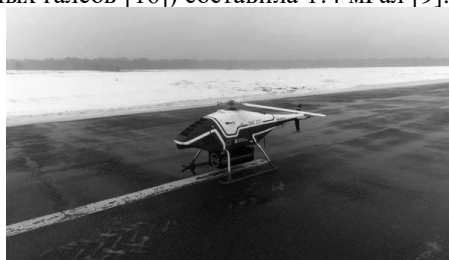
Рис. 8. Беспилотный летательный аппарат (БАС-200) с прикрепленным бескарданным аэрогравиметром. Фото компании «Аэрогеофизика»
