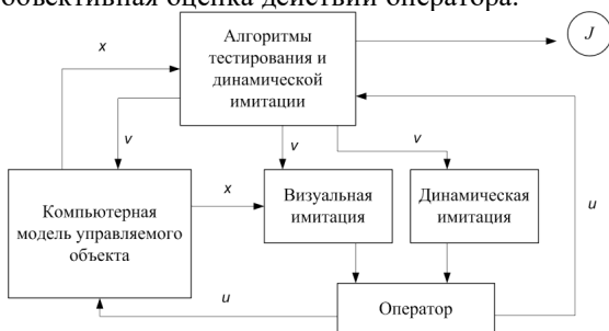
Рис. 1. Функциональная схема тестирующего тренажера
