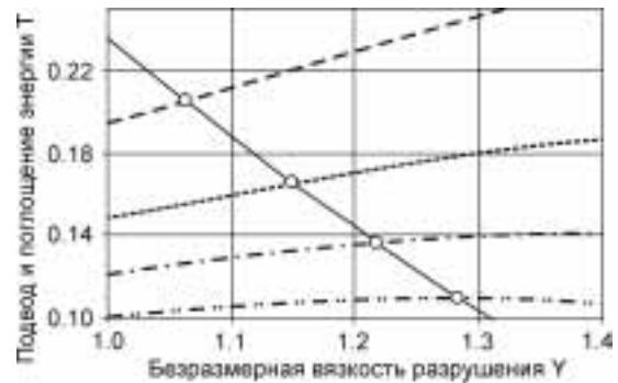
Рис. 4. Возрастающие кривые — графики подвода энергии для образцов с одним боковым разрезом, имеющих различную толщину. В точках пересечения этих кривых и графика поглощения энергии (убывающая кривая) происходит переход от устойчивого к неустойчивому разрушению. Самая нижняя кривая соответствует образцу бесконечной толщины. Крестиками отмечены критические точки
