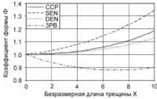
Рис. 16. Зависимость коэффициента формы \Phi от безразмерной длины трещины X для различной геометрии образцов, \omega = 40 . CCP — плоский образец с центральной трещиной; SEN — образец с одним боковым надрезом; DEN — образец с двумя боковыми надрезами; 3PB — образец для испытаний на трехточечный изгиб
