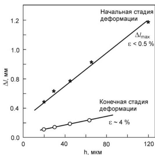
Рис. 4. Изменение расстояний между трещинами при вариации толщины упрочненного слоя и на разных стадиях деформирования
