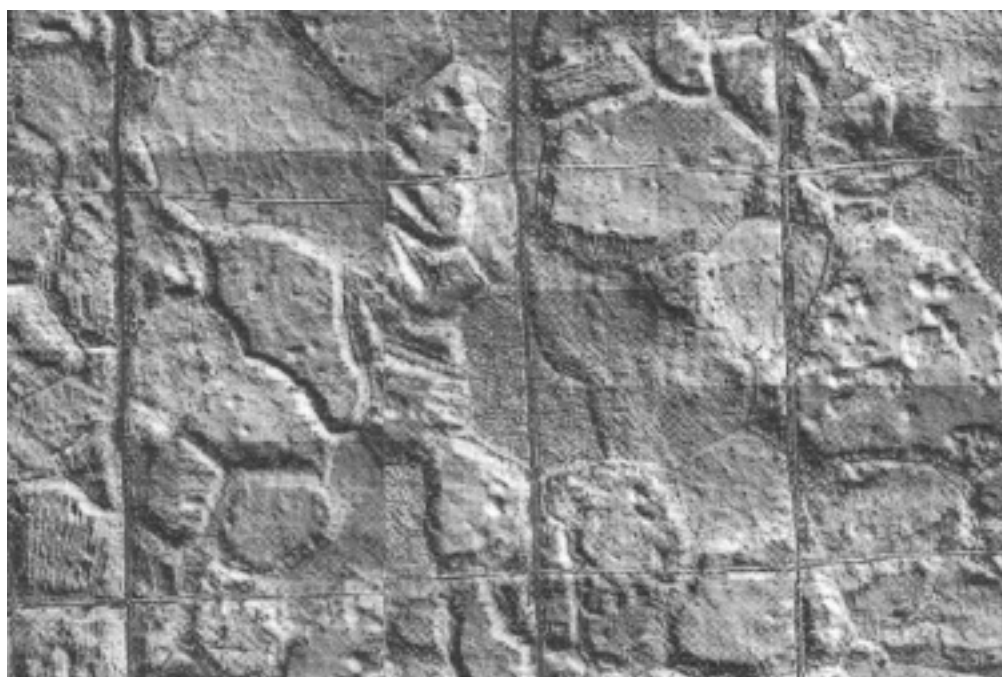
Рис. 7. Суперпетли из конгломератов зерен в наводороженном в течение 3 часов поверхностном слое титана после 35 \cdot 10^6 циклов нагружения. DIC. \times 500
