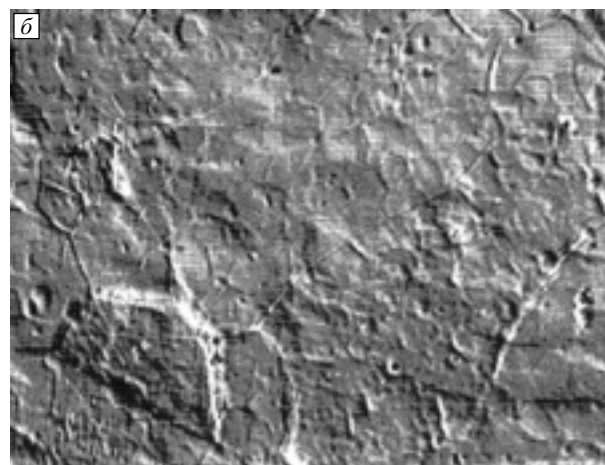
Рис. 2. Структура рекристаллизованного титана до (а) и после (б) наводороживания. \times 370
